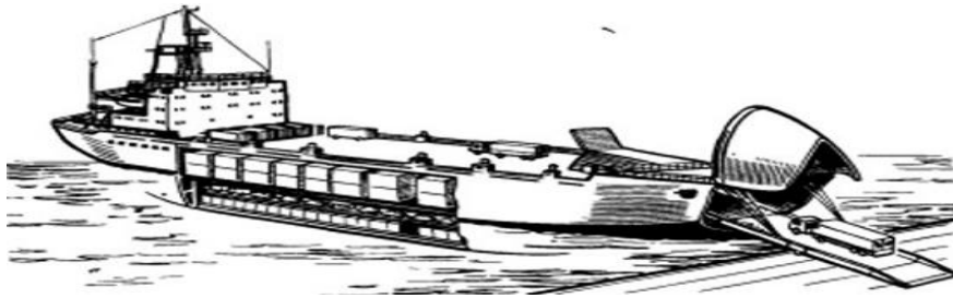
Рис 16. Схема судна с горизонтальным способом грузообработки.
